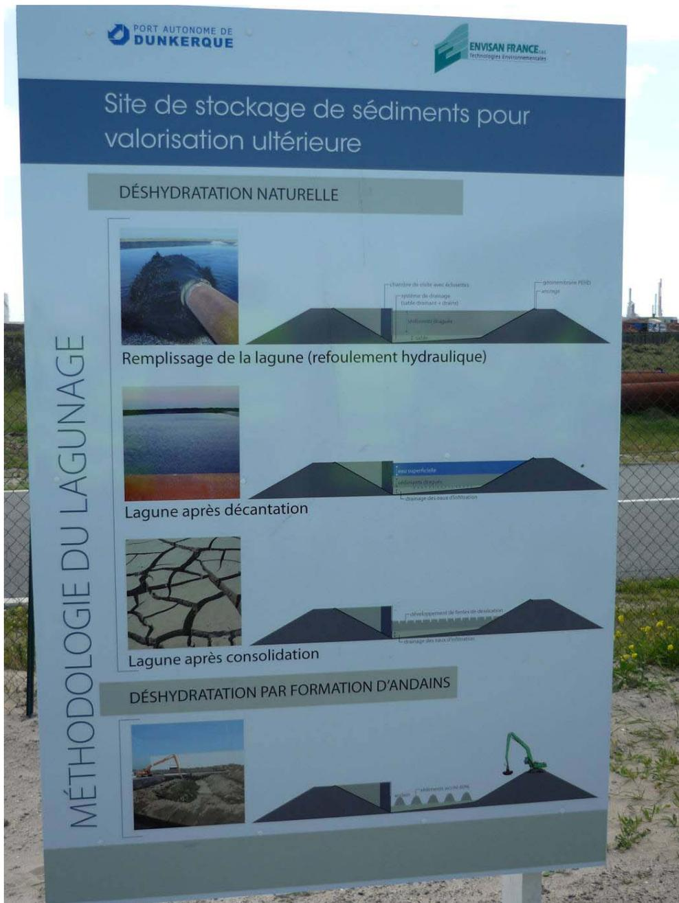
Figure 7.4 Méthodologie du lagunage : site de Dunkerque
