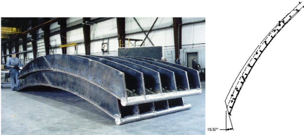
Figure 2.50 Illustration des clapets et de leur profil
