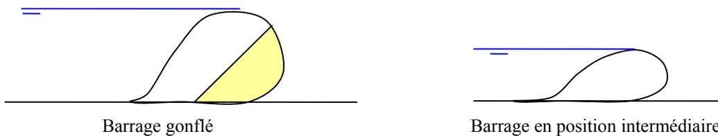
Figure 2.46 Système à deux chambres
